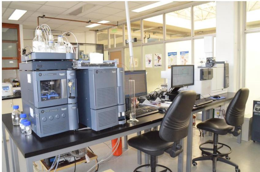
Foto 6: Vista en primer plano del Sistema UHPLC MS MS.
