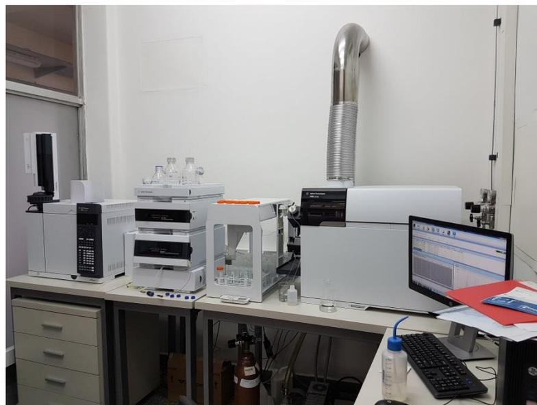
Foto 4: Vista del Sistema de ICP MS con acople a HPLC.
