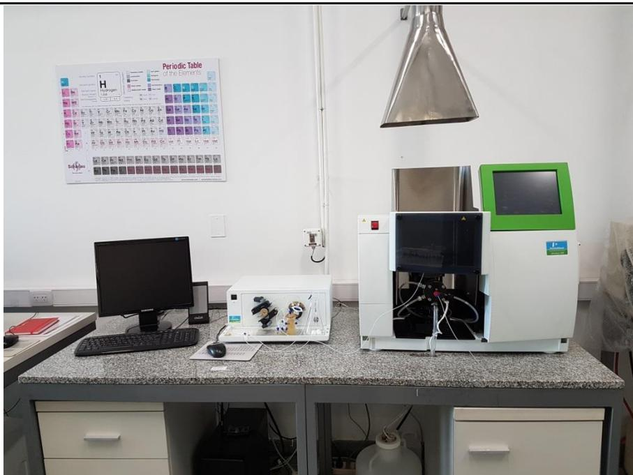
Foto 3: Vista del Sistema de Inyección de Flujo y Espectrofotómetro de Absorción Atómica de Llama .
